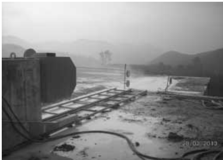
圖8.7 用金剛石線切割機作縱向切割
