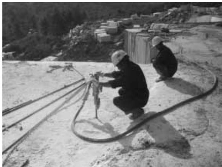
圖8.5 用鑿岩機作縱向鑽孔
