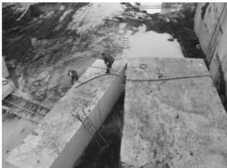
圖8.12 將翻轉後的大塊長方形石切成小型商用荒料
